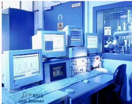
Bild 10: Prüfstand mit KFO-System zur Brennverfahrensentwicklung
